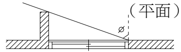
圖 6-1 僅設置之一側之垂直遮陽版，則實際遮陽效果 K_i' = 1 - (1 - \text{表 3 所查得之 } K_i) \div 2 。
